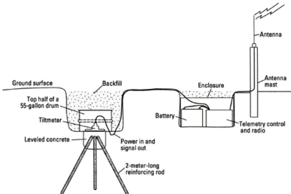
Fig. 2 Tiltmeter [9]
